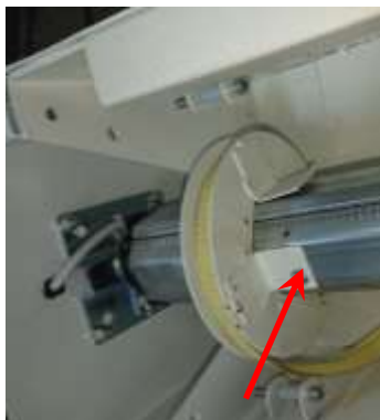
Позиционирование катушки на октогональном валу
