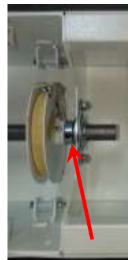
Установка стопорного кольца
